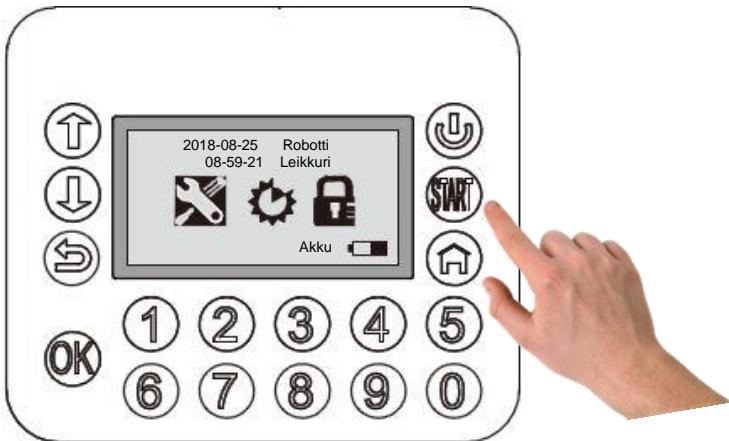
Leikkuksen aikana akkukapasiteetti on valvottu ja näkyy näytöllä.
