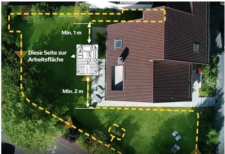
Lassen Sie dem Begrenzungskabel eine zusätzliche Länge von ungefähr 1 Meter und sichern Sie es von der Rückseite der Ladestation nach vorn verlaufend mit den Heringen. **Verlegen Sie das Kabel immer entgegen des Uhrzeigersinns.**
