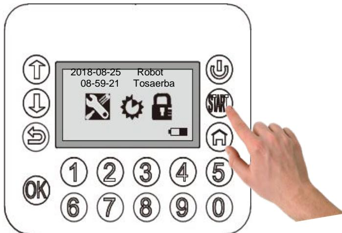
Durante il funzionamento, il livello di carica della batteria viene monitorato e riportato sul quadrante.
