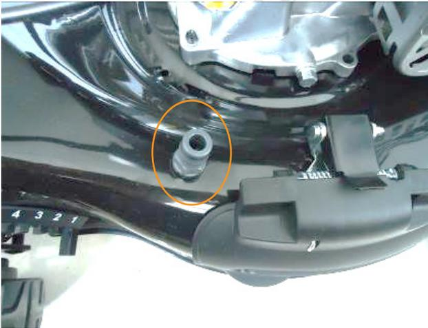
2. Verbinden Sie das andere Ende des Schlauchs mit dem Wasserhahn.
