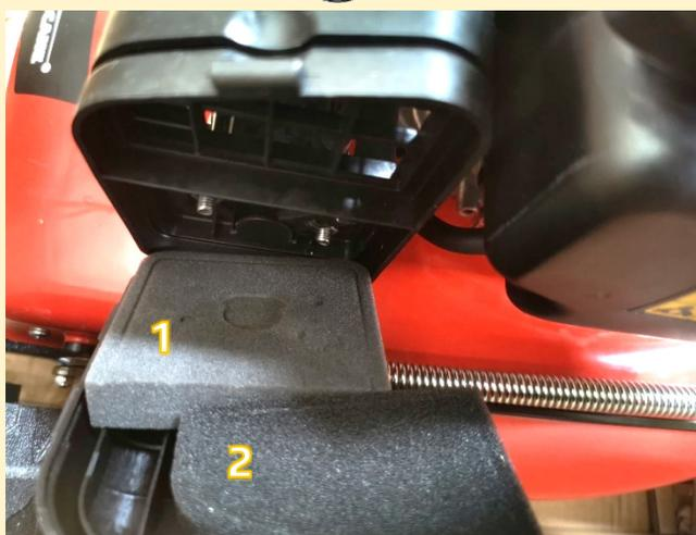
Reinigen Sie die beiden Filterelemente 1 und 2 in einer Reinigungslösung. Lassen Sie die Filterelemente mindestens 12 Stunden an der Luft trocknen.
