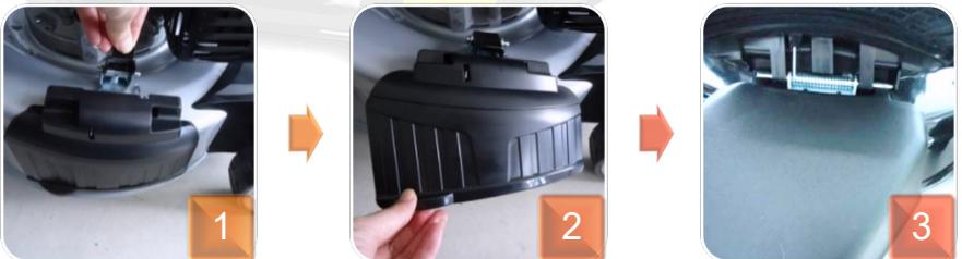
Schritte durch: Führen Sie den Mulchaufsatz (22) in die hintere Öffnung ein.
